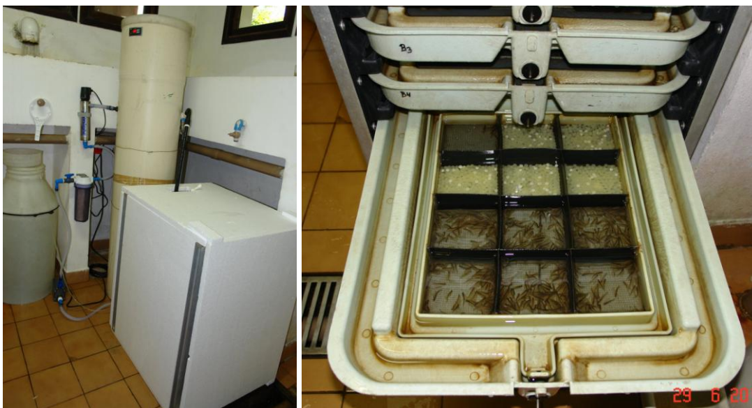
Figura 1: Sistema de circuito fechado com refrigeração, filtragem e desinfecção da água para incubação de ovos de Salmo salar (A) e incubadora com gaveta aberta (B).
